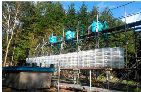
図2 技術スタッフが作成した循環式の水槽システム。川の水を青いタンクまでくみ上げ、各水槽へ水を分配する。分配される水は背部に取り付けられたボイラーにより5°C程度温度を上げることが可能。河川生態系が地球温暖化に対してどのような応答をするのかを調べる目的で作成された。
